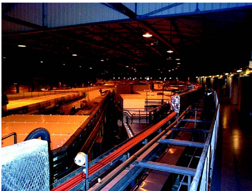
Figura 1. Imagen interior del sincrotrón de Grenoble. Las líneas de luz salen tangencialmente del anillo por el que circulan electrones a velocidades cercanas a las de la luz
